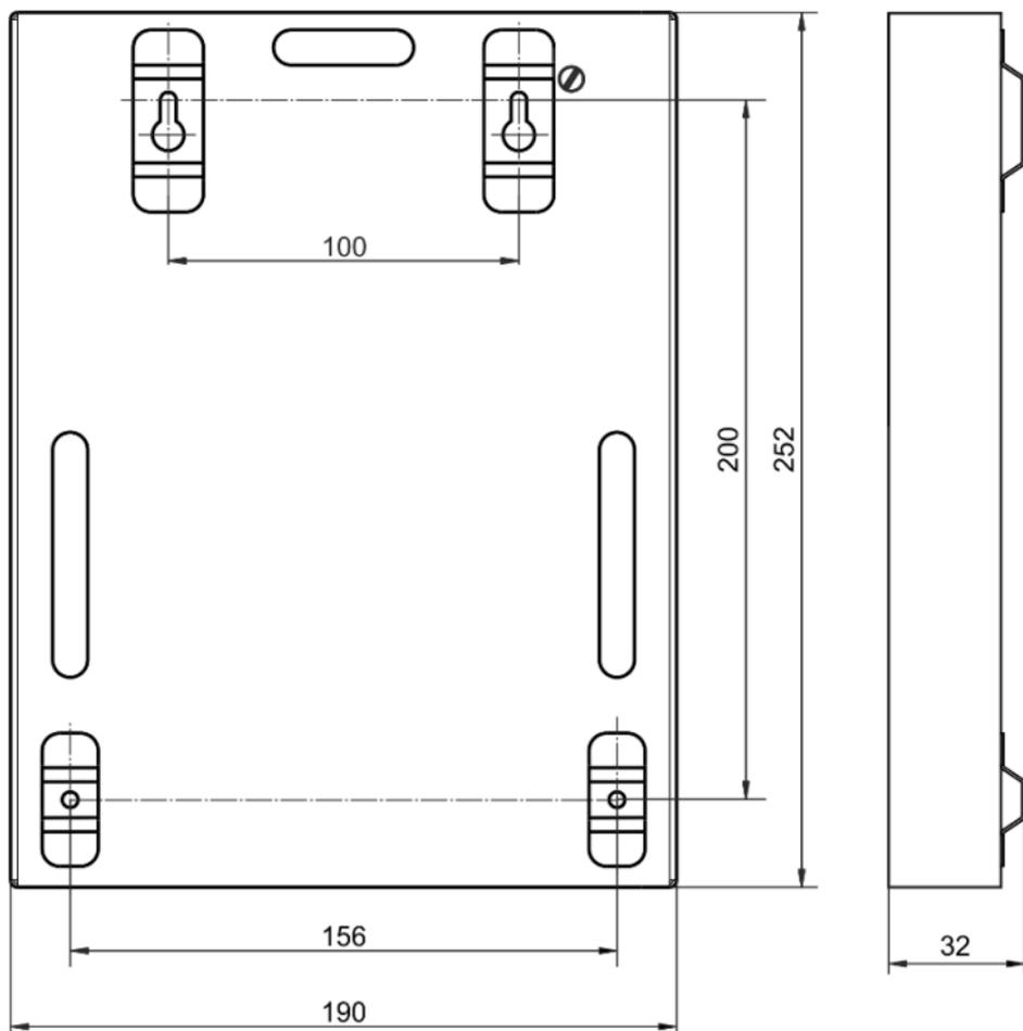
Рисунок А2. Размеры и места креплений
