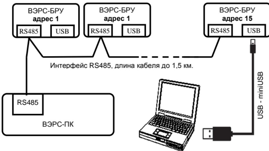
Рисунок А4. Структурная схема связи приборов ВЭРС-БРУ с ВЭРС-ПК(2,4,8,16,24) Версия 3.2.
