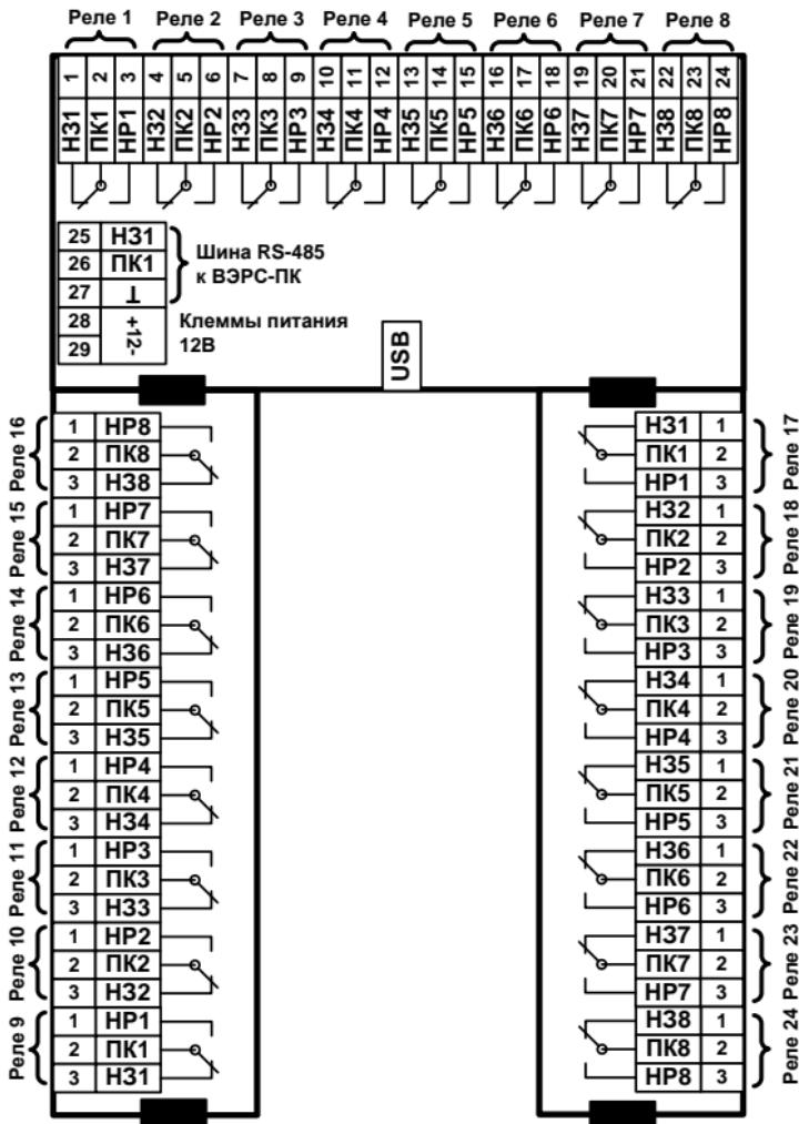
Рисунок А3. Схема внешних соединений ВЭРС-БРУ.
