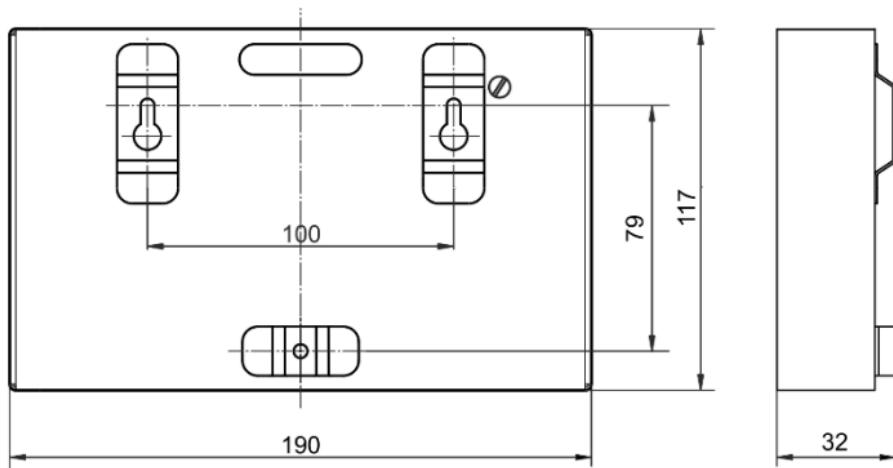
Рисунок А1. Внешний вид передней панели,
