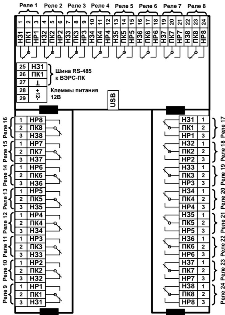
Рисунок А3. Схема внешних соединений ВЭРС-БРУ.
