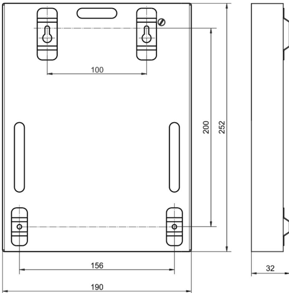
Рисунок А2. Размеры и места креплений
