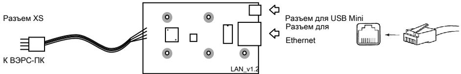
Рисунок Б3. Внешний вид сетевого преобразователя ВЭРС-LAN.
