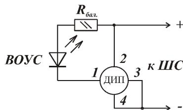
Рис. 7. Схема подключения извещателей типа ДИП с ВУОС.
