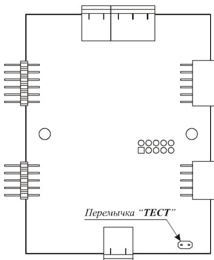
Рис. 3. Расположение перемычки «ТЕСТ» на ПП модуля МВК-П.
