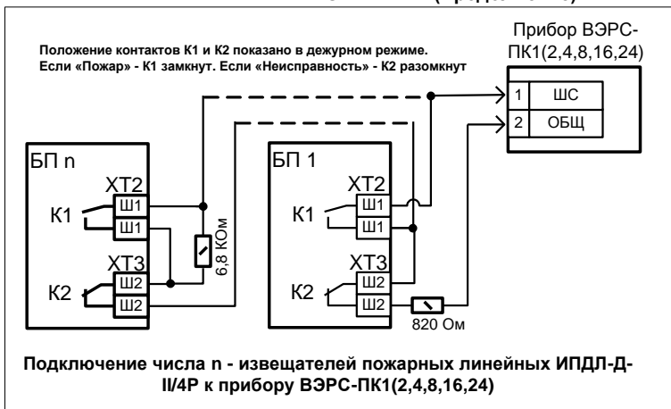
Рисунок Б5. Схема включения линейных дымовых извещателей ИПДЛ-Д-II/4P.
