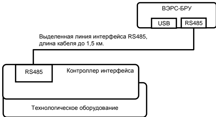
Рисунок А5. Структурная схема связи прибора ВЭРС-БРУ с технологическим оборудованием в режиме работы открытого протокола.
